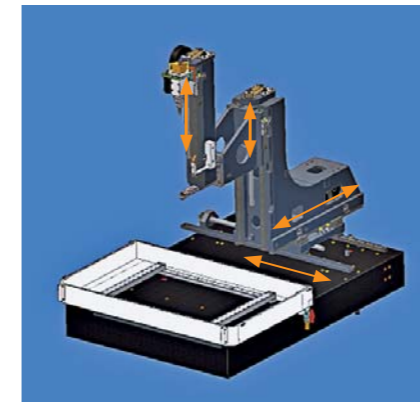
Рис. 4. Конструкция станины и компоновка станка.
