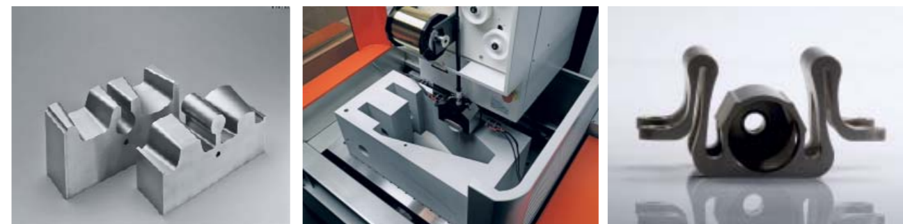
ШЕРОХОВАТОСТЬ RA 0,2 МКМ ПРИ УГЛОВОЙ ОБРАБОТКЕ
