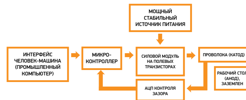
РИС. 2 УПРОЩЕННАЯ БЛОК-СХЕМА ГЕНЕРАТОРА
