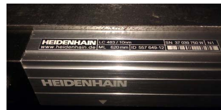
РИС. 8 ЛИНЕЙНЫЙ ДАТЧИК ПОЛОЖЕНИЯ ОСИ X (ОПТИЧЕСКАЯ ЛИНЕЙКА)
