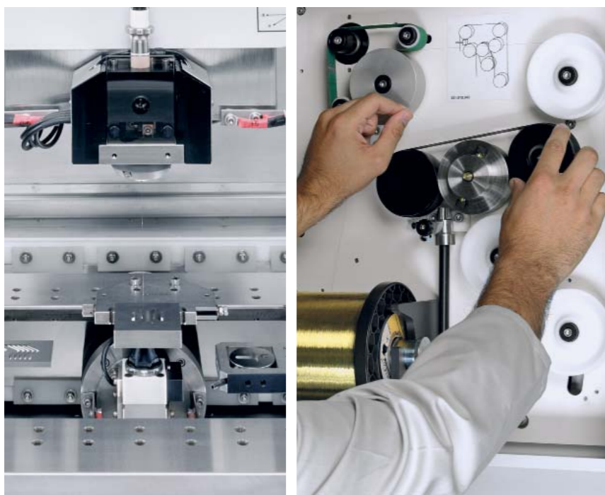
РИС. 5 РАБОЧЕЕ ПРОСТРАНСТВО СТАНКА CUT 20 P И ВОЗМОЖНЫЕ ГАБАРИТЫ ЗАГОТОВКИ
